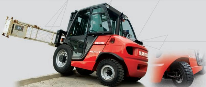
I carrelli MSI assicurano una grande stabilità nella fasi di carico e scarico e sono contraddistinti da una **raggio di sterzata estremamente compatto**, grazie ad un nuovo assale posteriore con il cilindro di sterzata integrato.
