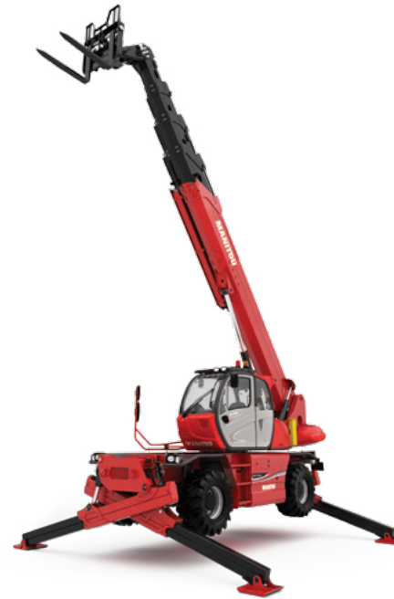
Rotation sur stabilisateurs déployés avec treuil 5000 kg
